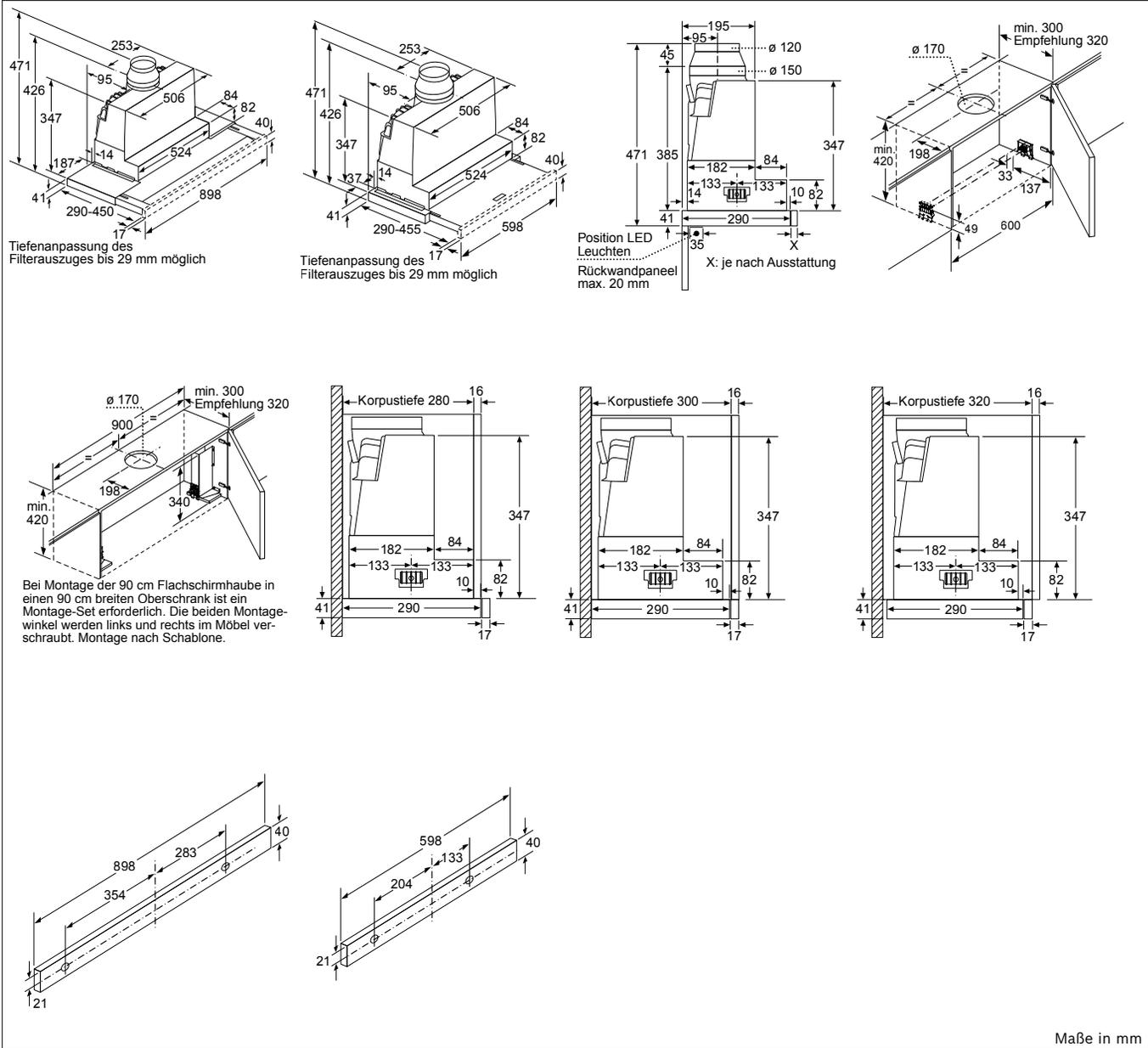
Tiefenanpassung des Filterauszuges bis 29 mm möglich
