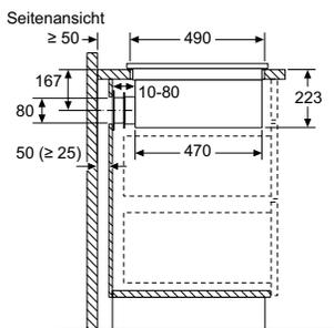
Bei der Installation direkt an einer nicht isolierten Außenwand ( $\mu \geq 0,5 \text{ W/m}^2\text{°C}$ ) empfehlen wir die Verwendung von Konfigurationen mit teilweise oder vollständig kanalisierter Rezirkulation.
